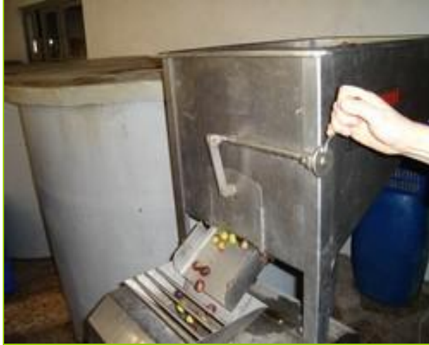
Resim 2.8: Standart tip çizme makinesinde zeytinlerin işlenmesi
