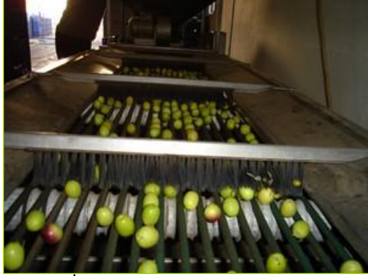
Resim 2.6: İp bantlı çizme makinesinde zeytinlerin işlenmesi
