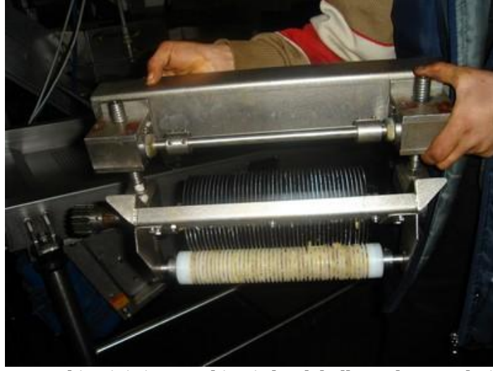
Resim 1.5: Kırma makinesini çizme makinesi olarak kullanmak üzere değiştirilen aparat
