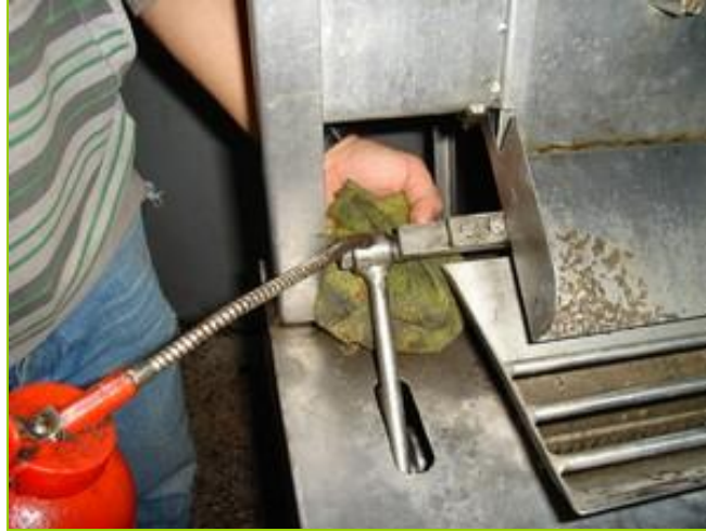
Resim 2.10: Çizme makinesinin yağlanması
