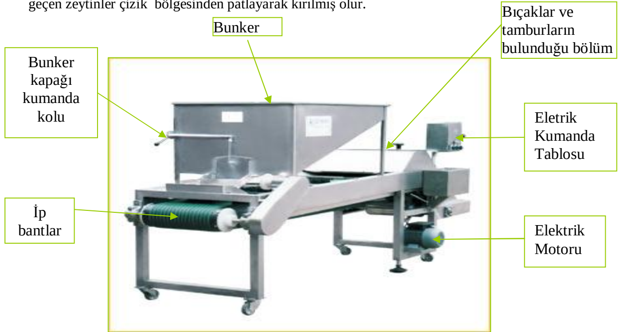
Resim 1.7: İp bantlı kırma makinesi
