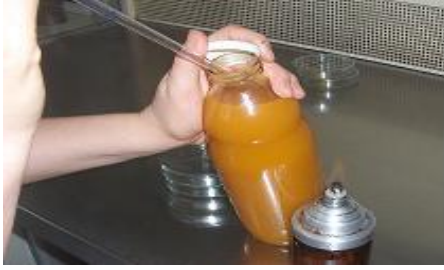
Resim 2.7-2.8 : Steril pipetle numunenin çekilmesi
