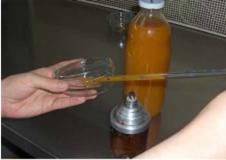
Resim 2.9: Numunenin petri kutularına aktarılması
