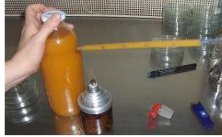
Resim 2.7-2.8 : Steril pipetle numunenin çekilmesi
