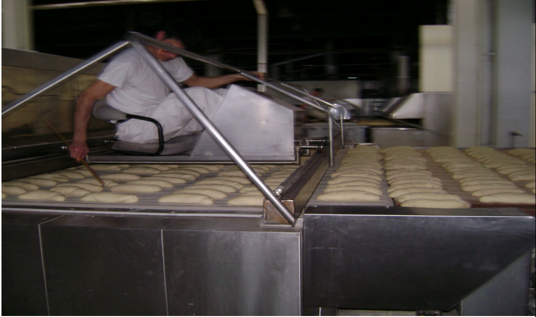
Resim 2.48: Hareketli sistemde bıçak atma işlemi
