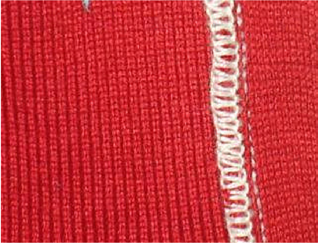
Resim 1.7: Kenar ile ribana birleştirme
