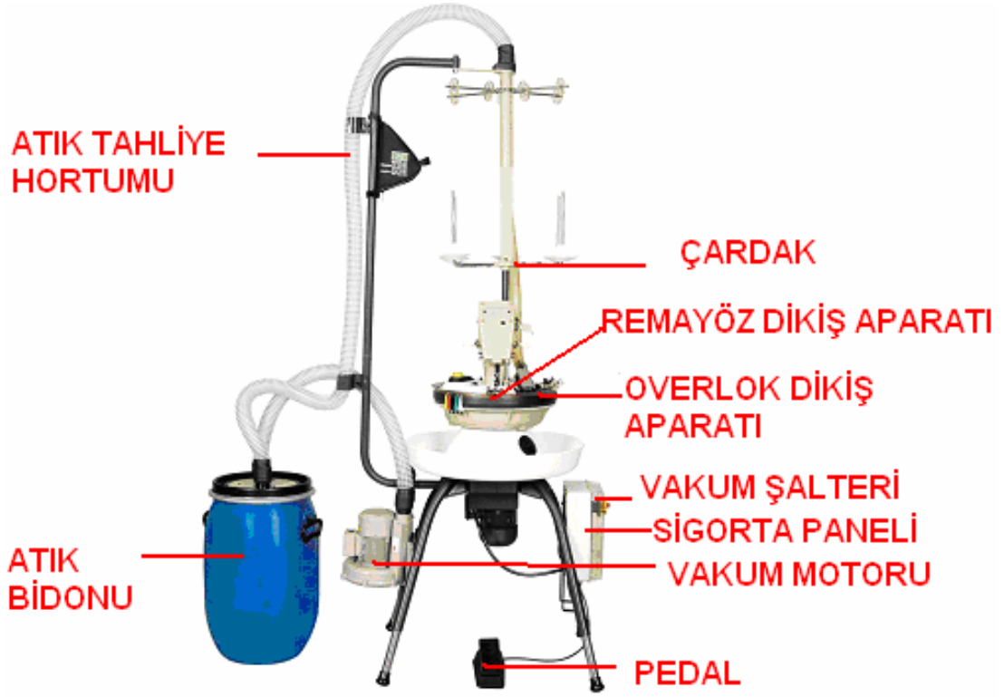
Resim 1.1: Overloklu remayöz makinesinin bölümleri
