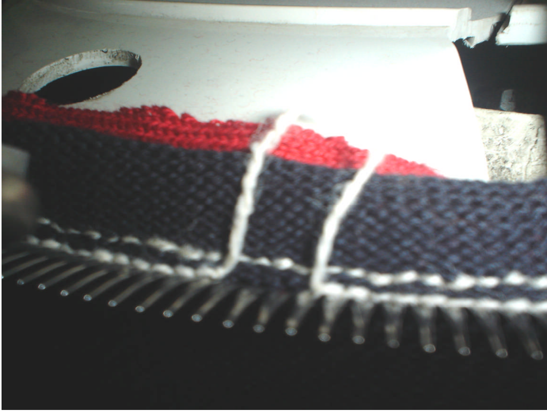
Resim 2.2: Overlok ve remayöz dikiş atlaması
