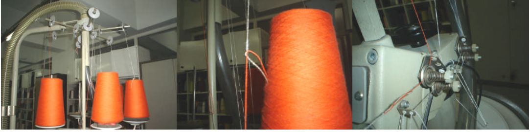
Resim. 1.24: Overloklu remayöz makinesinde iplik deęiřtirme
