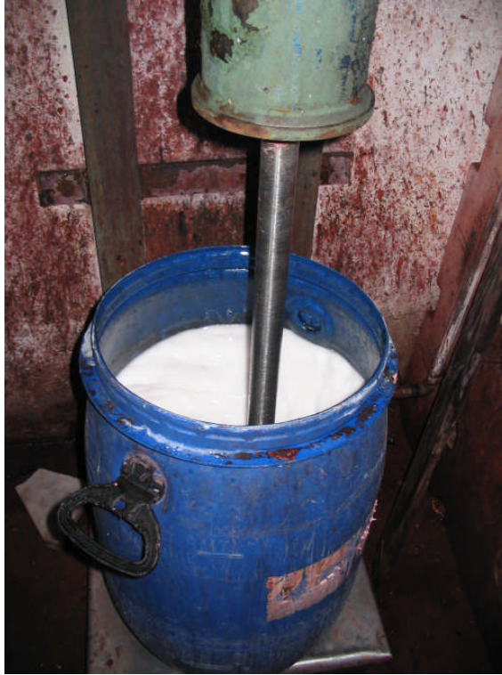
Resim 1. 3: Boyar madde ve kimyasalların mikserle karıştırılması
