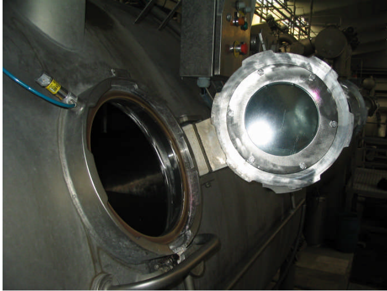
Resim 1. 12: Kumaşın yerleştirildiği kapak
