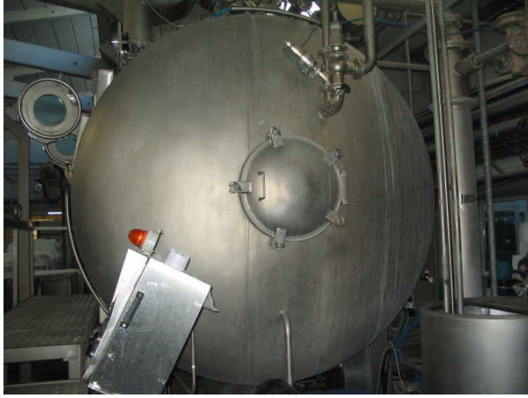
Resim 1. 9: Makinenin boyama kazanı yan görünüşü
