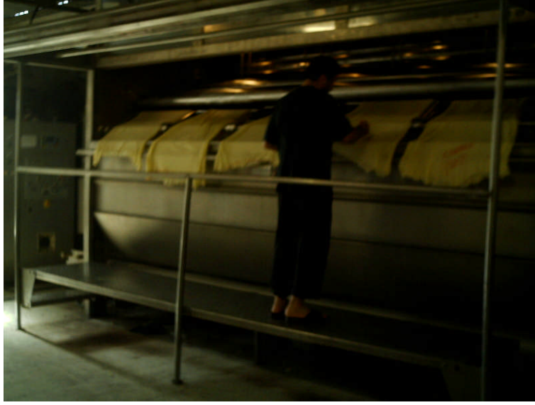
Resim 2. 9: Tüm bölmelere kumaş yerleştirilmesi
