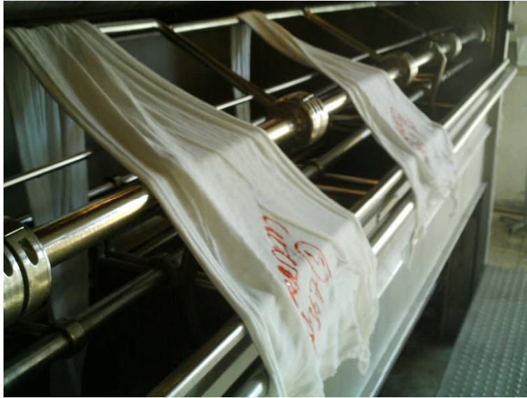
Resim 2. 8: Makineye kumaşın yerleştirilmesi
