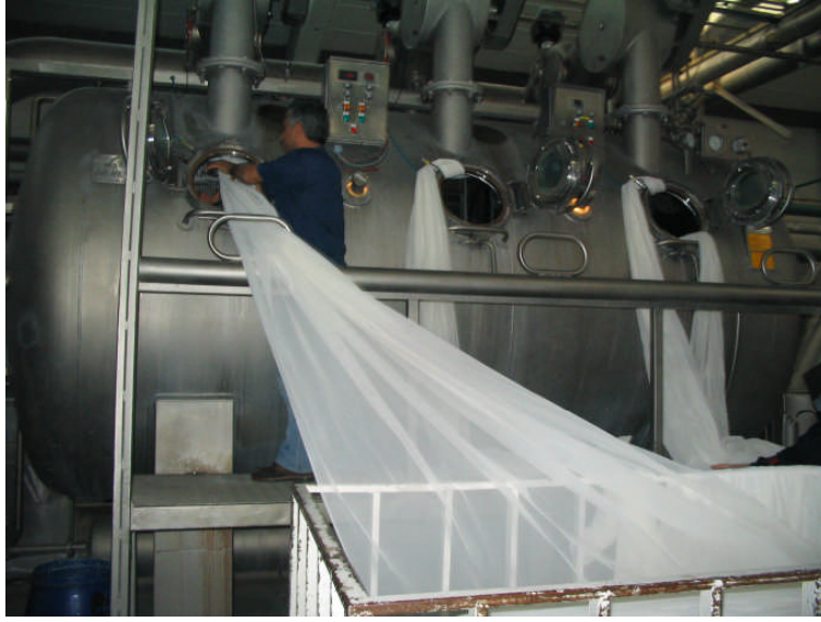
Resim 1. 18: Makinenin tüm bölmelerine kumaş yerleştirilmesi
