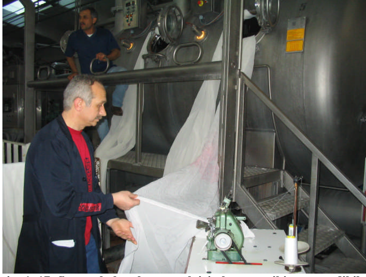
Resim 1. 17: Sonsuz halat oluşturmak için kumaşın iki ucunun dikilmesi
