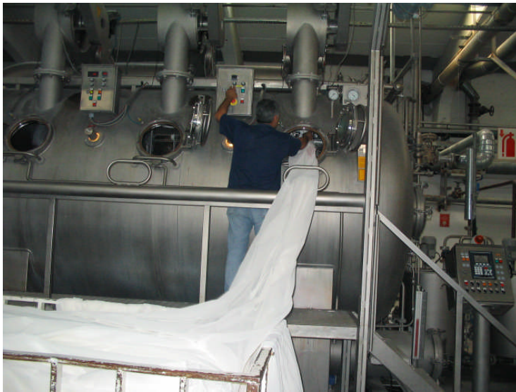
Resim 1. 14: Kumaşın makineye yerleştirilmesi
