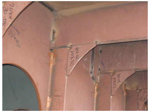
Resim 1.6: Double bottom bloğundaki tülani stifner bağlantısını yapan braketler
