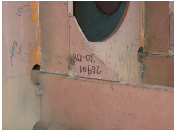
Resim 1.8: Double bottom bloğunda stifner ile tülaniyi birleştiren braket
