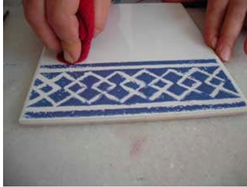
Resim 4.1: Desenin fazlalıklarının bez ile silinmesi
