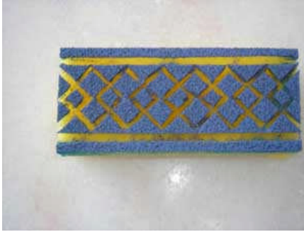
Resim 1.1a-b: Deri sertliğindeki çamur üzerine sünger dekoru uygulaması
