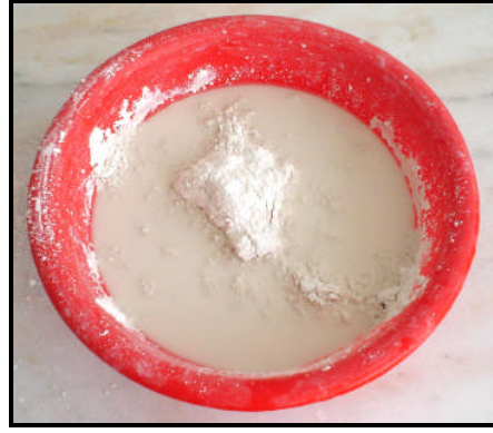
Resim3.3: Su yüzeyinde tepcecik oluşumu
