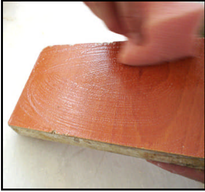
Resim.2.7: Arap sabunu ile yalıtma
