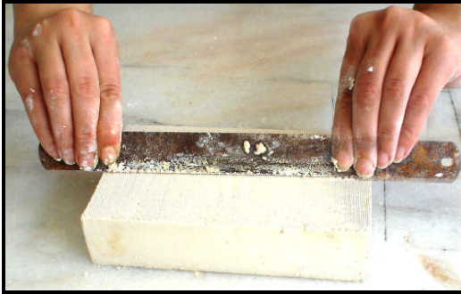
Resim4.11:Demir testeresi ile yüzeyi gönyeye getirme
