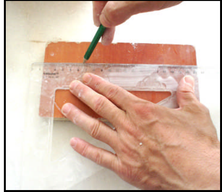
Resim.2.6: Yükseklik ölçüsünü markalama
