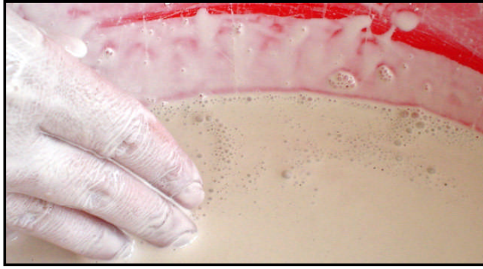
Resim3.6: Alçı içinde hava kabarcıkları
