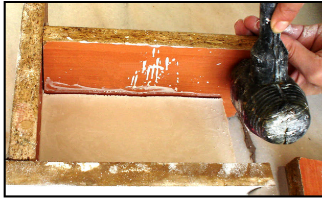
Resim3.8: Kurgu çerçevelerinin çıkarılması
