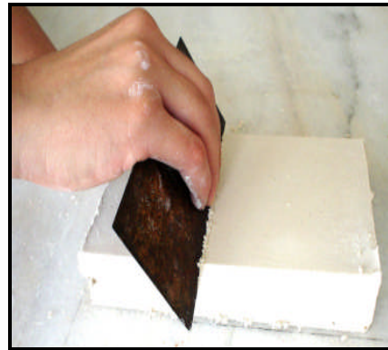
Resim4.7:Alçı plakasının sistire ile talaşlarının alınması
