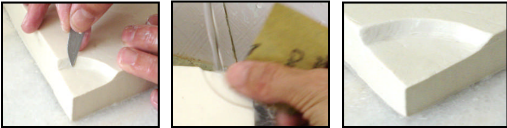
Resim5.8: Köşede yarım yuvarlak pim açma aşamaları
