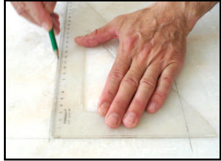
Resim.2.4: Masa üzerine markalama
