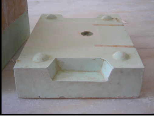
Resim 1.10:Teksir kalıpta köşeli pim uygulama
