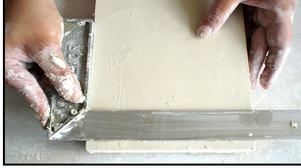
Resim.4.8:Alçı plakasının yüzey düzlemlik kontrolü
