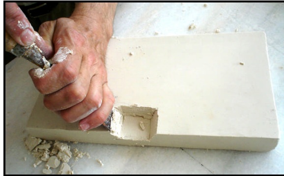
Resim5.4: Belirli bir eğimde aç oluşturma
