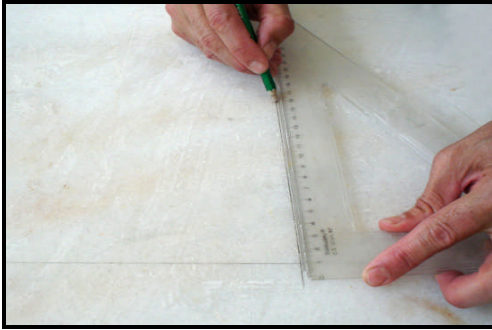
Resim.2.3: Masa üzerine markalama
