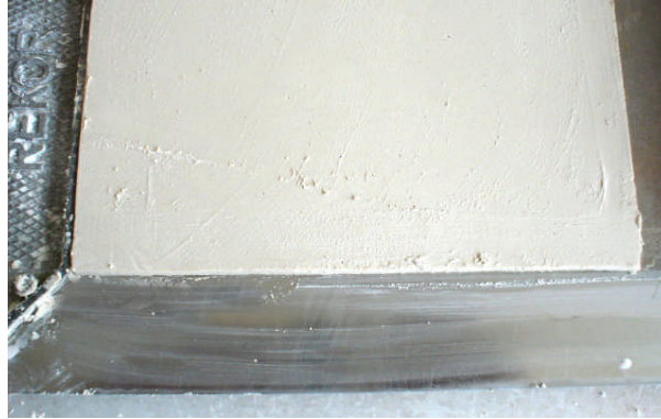
Resim.4.1:Gönye ile açı kontrolü
