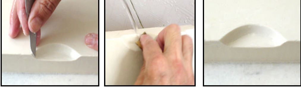
Resim5.9: Yarım yuvarlak pim açma aşamaları
