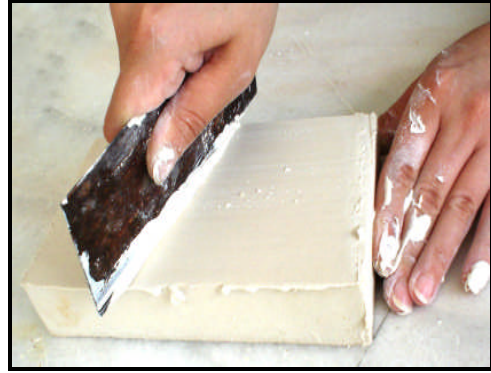
Resim4.10: Sistire ile yüzeyi düzeltme
