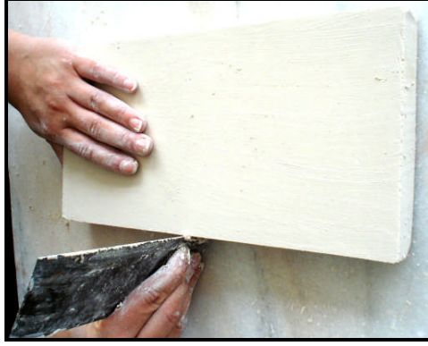
Resim 4.15: Sistire yardımı ile kenar düzeltme işlemi
