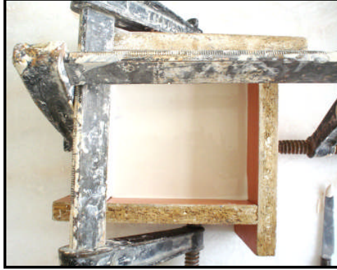
Resim2.11:İşkence ile (bağlayıcı)desteklenmiş kurgu
