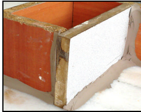
Resim.2.10 : Alçı sızdırmazlığını sağlama
