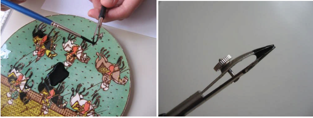
Resim 3. 7: Mürekkep ile doldurulan trilin haznesi
