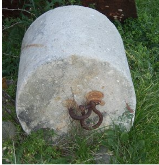
Resim 1.4: Kazıkları batırmakta kullanılan ağırlıklar
