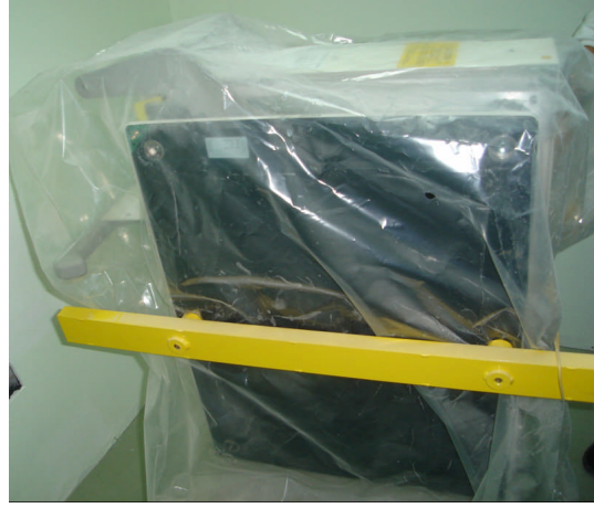
Resim 3.7:Kolimatör arabasına takılan koruma aparatının yandan görünüşü
