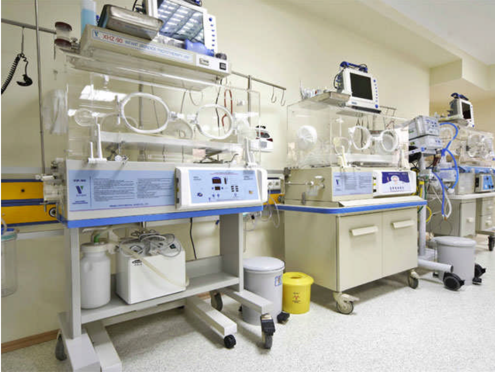
Resim 5.4: Gelişmiş kuvöz görüntüleme ve monitör cihazları
