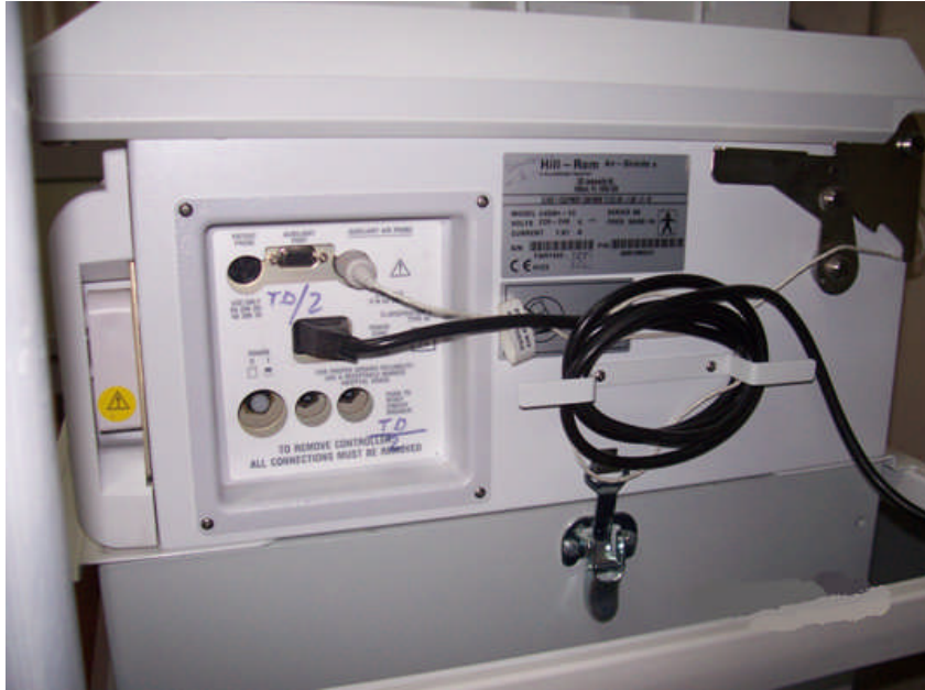
Resim 5. 6: Kuvöz güç giriş ünitesi ve görüntüleme sistemi terminalleri
