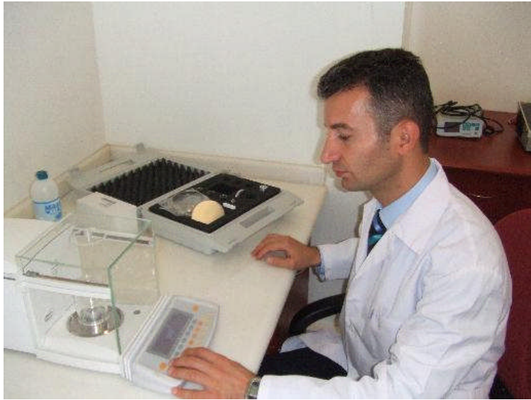
Fotoğraf 4.3: Pipet kalibrasyonu(*)
