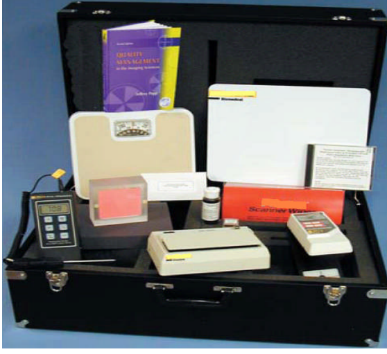
Fotoğraf 2.3: Mamografi sistemlerinde kullanılan kalite kontrol uyumluluk (compliance) kiti
