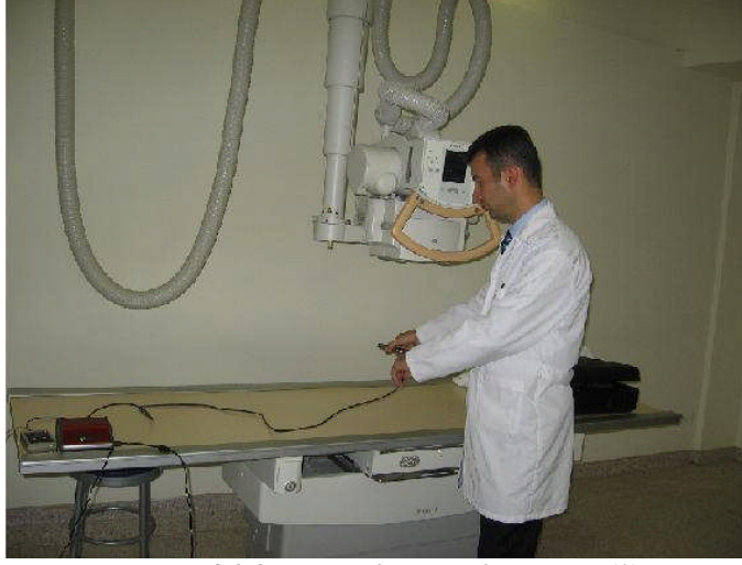
Fotoğraf 4.4: X-ray cihazı kalibrasyonu(*)
