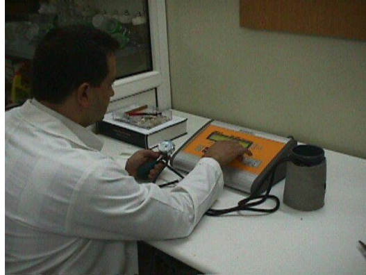
Fotoğraf 4.6. NIBP analizörle tansiyon aleti testi
