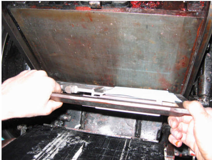
Şekil 2.2: Kalıp arkasından yapılan besleme
