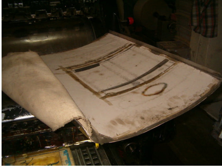
Şekil 2.3: Silindir kazanlı tipo baskı makinesine takılan çelik plaka
