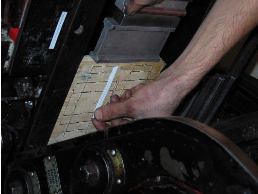
Şekil 2.9: Kalıp arkasından mizantren yapılması
