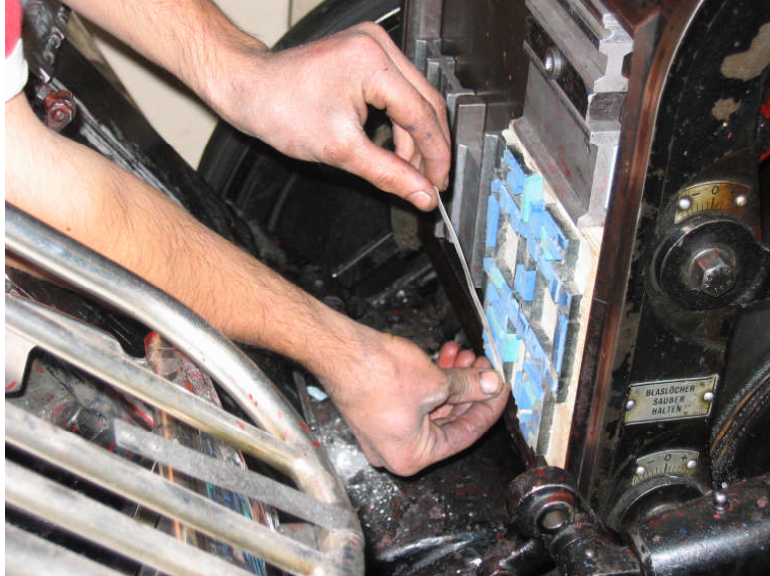
Şekil 2.5: Elle hazırlanmış konik bandının keski kalıbına yapıştırılması
