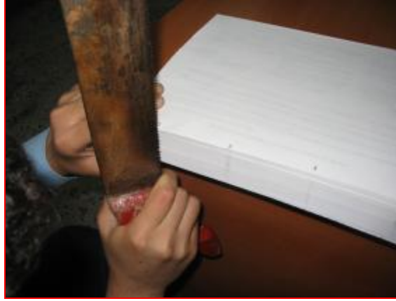
Resim 3.2: Testere ile kâğıt bloğunun 45 derece kesilmesi
