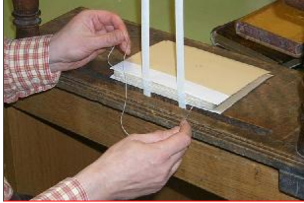
Resim 1.9: İplik dikişi tezgahında yapılan ekstrafor (bantlı)dikiş yöntemi
