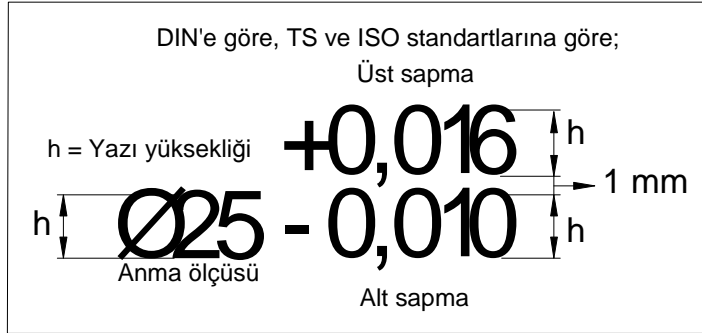
Şekil 2.6. Toleranslı Ölçü Gösterilme Standardı
