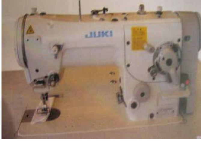
Resim 2.2: Mayo üretiminde kullanılan zikzak dikiş makinesi
