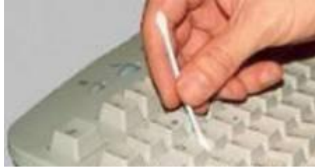
Resim 1.6: Klavye aralarının temizlenmesi
