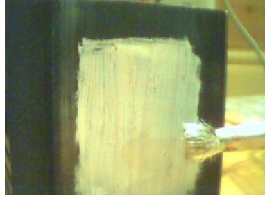
Resim 1.16: Heatsink üzerine termal macun uygulanması
