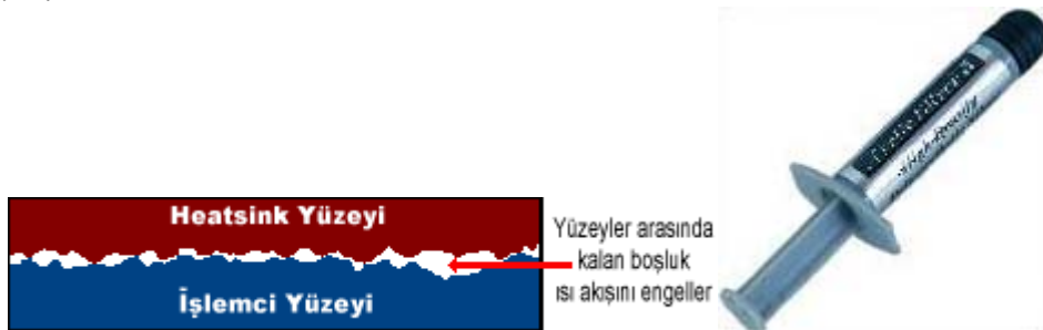
Şekil 1.3: Termal macun uygulama yüzeyi ve termal macun
