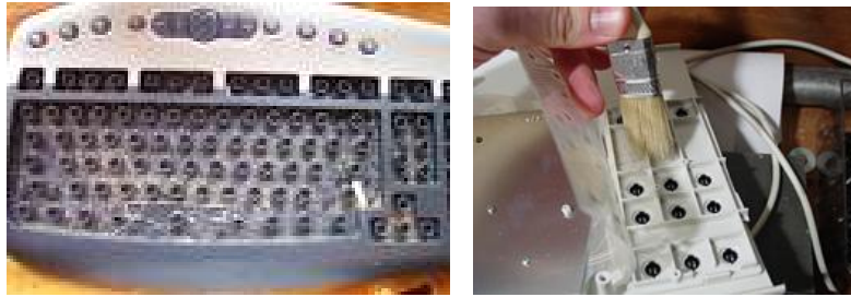
Resim 1.9: Tuşları çıkarılmış klavye ve temizliği
