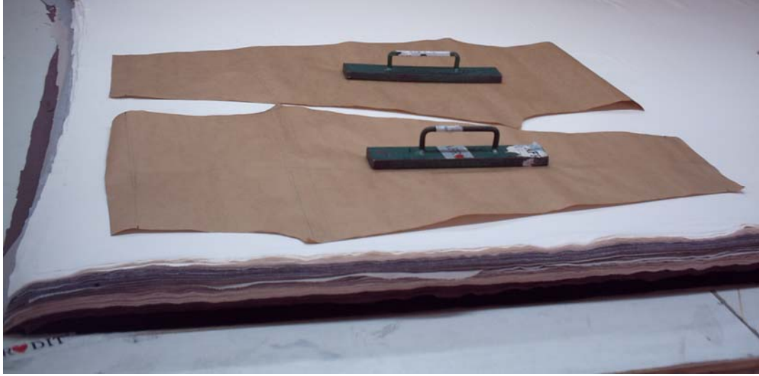
Resim 1: Tayt kalıbının pastala yerleştirilmesi.
