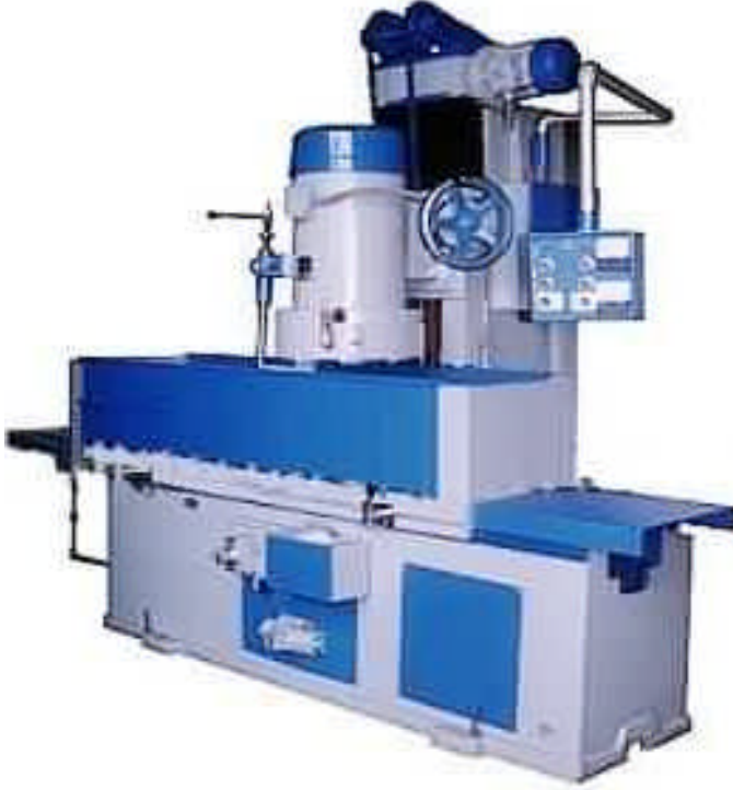
Resim 2.2: Düşey Milli Düzlem Yüzey Taşlama Tezgahları
