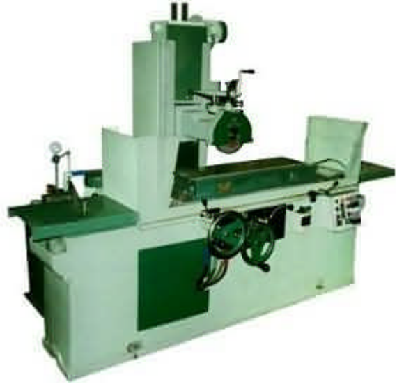
Resim 2.1: Yatay Milli Düzlem Yüzey Taşılama Tezgahı
