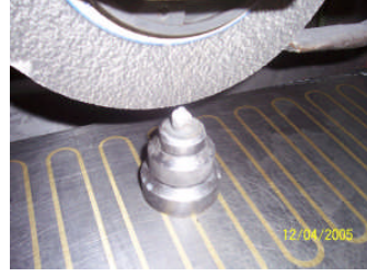
Resim 1.8: Zımpara Taşlarının Bilenmesi
