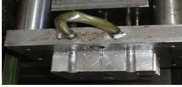
Resim 2.13: Soğutma rakorlarını bağlama
