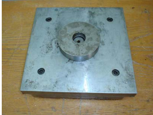
Resim 2.12: Merkezleme flanşını bađlama
