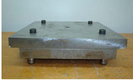
Resim 2.11: Bađlama plakası montajı
