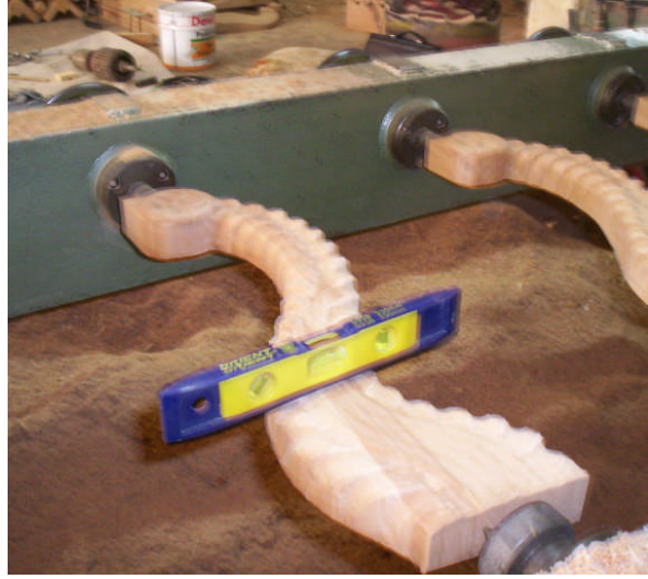
Resim 2. 14: Su terazisi ile bağlama
