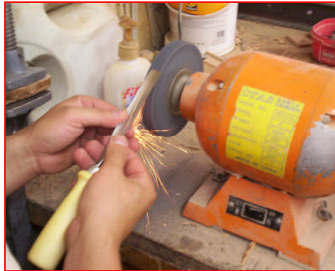
Resim 1.19: Oyma kalemlerini zımpara taşında bileme
