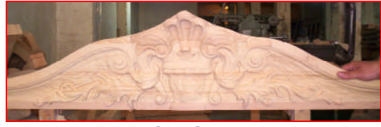
Resim 2. 24: Makine kopya oyma örneği
