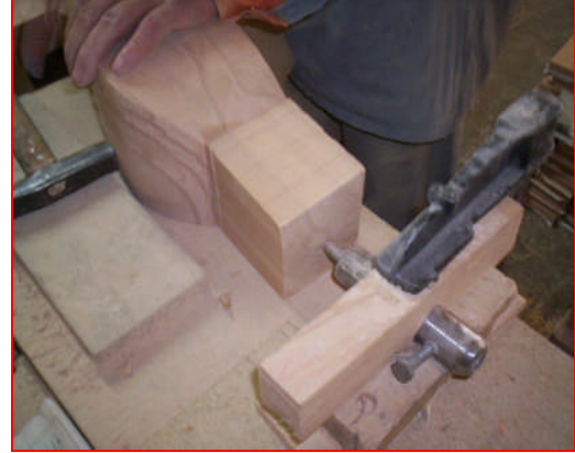
Resim 2. 17: İş parçası merkezlemesi
