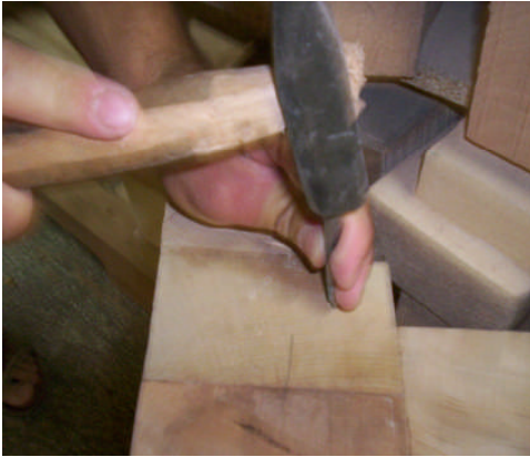
Resim 2. 17: İş parçası merkezlemesi
