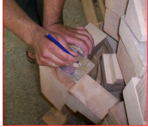
Resim 2. 16: İş parçası markalaması
