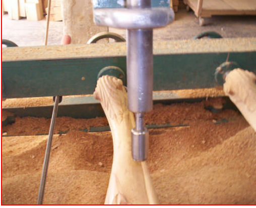
Resim 2. 20: Kılavuz parçası hareketleri
