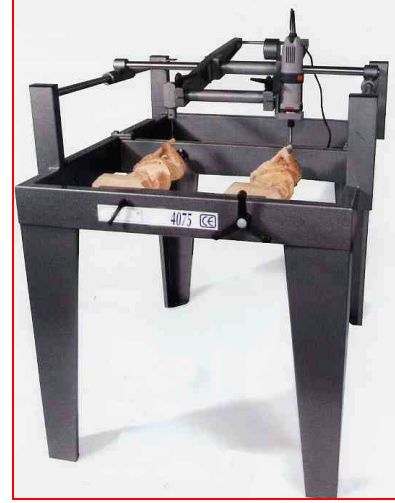
Resim 2. 3: Bir (tek) bıçaklı oyma makineleri
