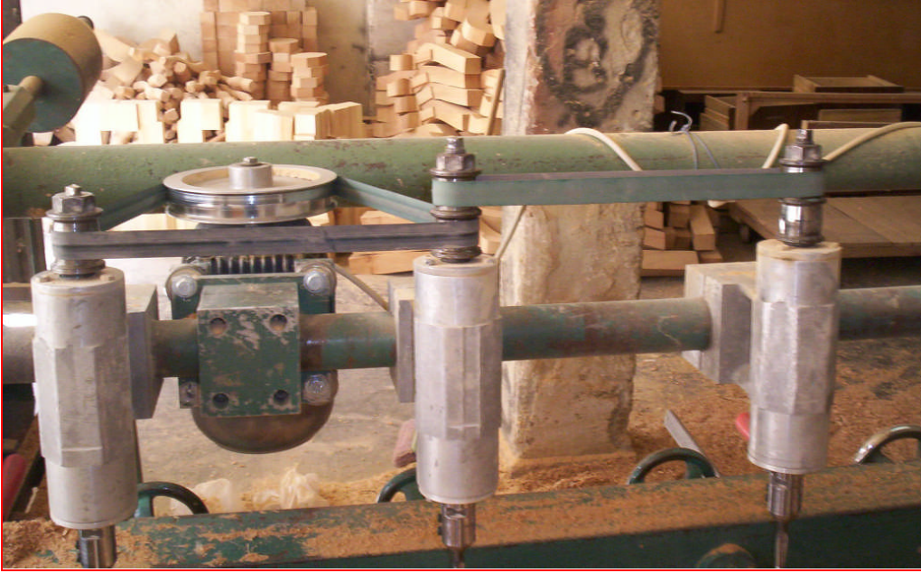
Resim 2. 7: Altı bıçaklı oyma makinesinde üç bıçağın tek motordan hareket iletimi
