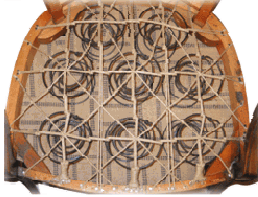
Resim 1.1: Sabit teloraya yapılmış döşeme zemini
