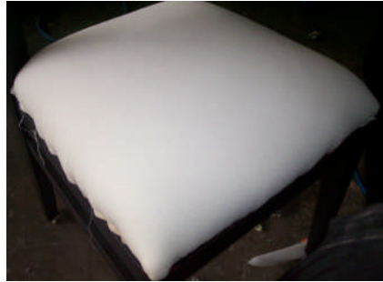
Resim 2.3: Kauçukla yapılmış döşeme dolgusu
