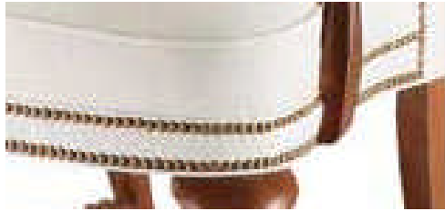
Resim 3.7: Kabara ile gizlenmiş ek yerleri
