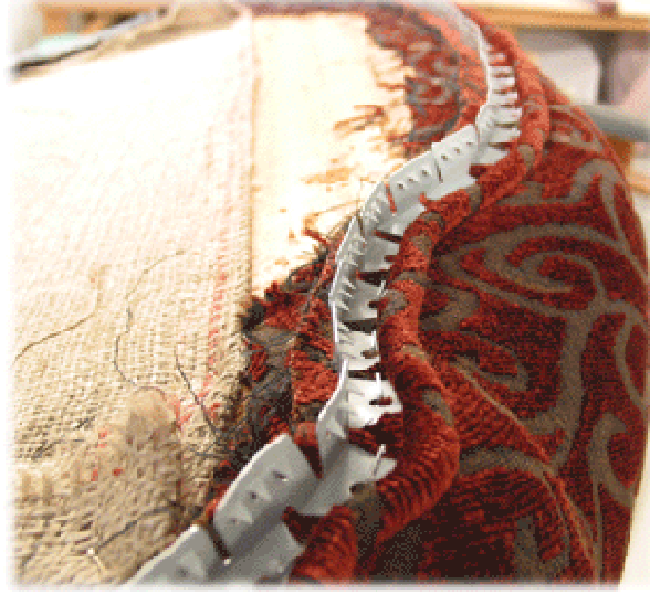
Resim 3.2: Döşemeye takılmış astar kumaşı
