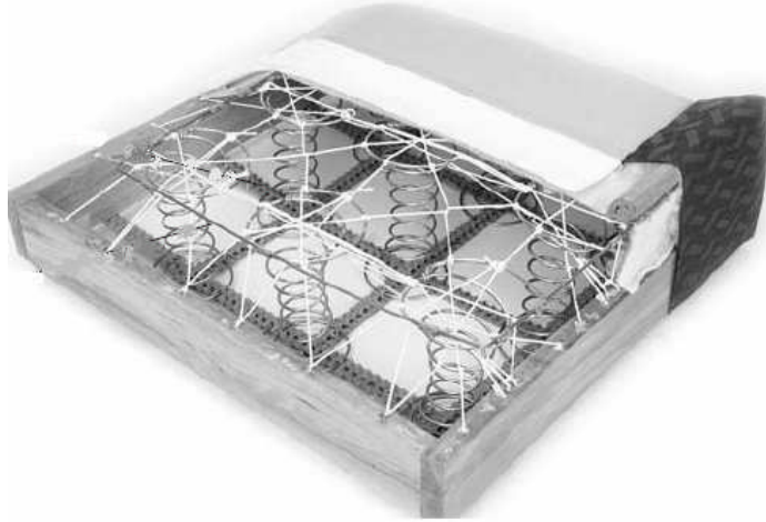
Resim 1.3. Seyyar teloraya yapılmış döşeme zemini
