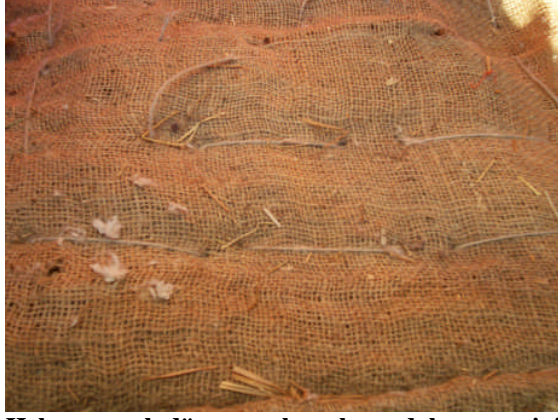
Resim 2.2: Helezon yaylı döşemeye konulmuş dolgu gerecinin dikilmesi
