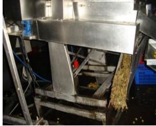
Resim 3.9: Su ile yıkama makinesinin temizlenmesi
