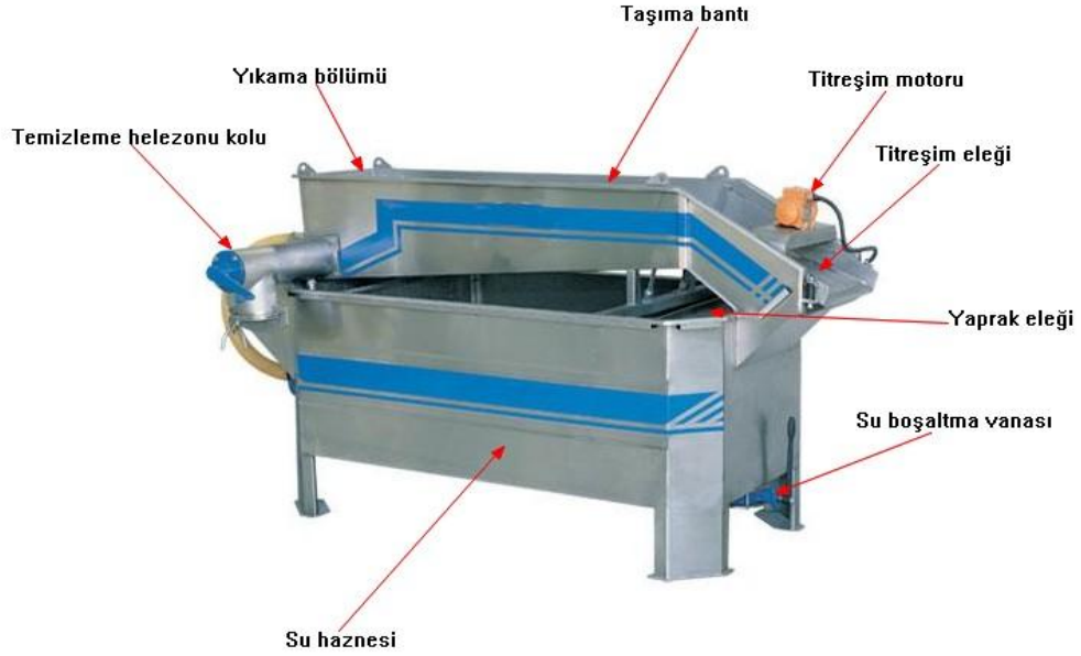
Resim 3.5: Zeytinyağı işlemede kullanılan yıkama makinesinin kısımları
