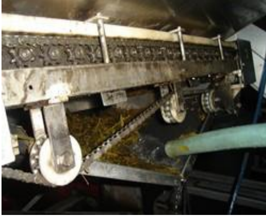
Resim 3.9: Su ile yıkama makinesinin temizlenmesi
