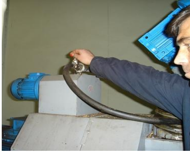
Resim 2.30: Kırma işleminde tıkanmaları önlemek için kırıcıya su ilave edilmesi
