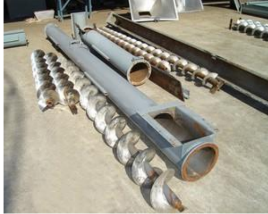
Resim 2.23: Bakım için sökülmiş çeşitli elevatörler
