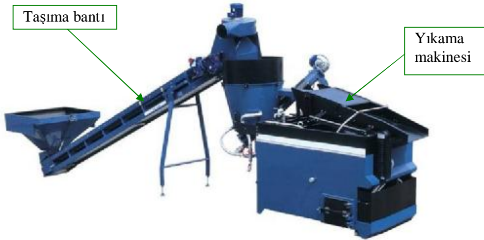
Resim 1.8: Taşıma bantı (konveyör) ve yıkama makinesi
