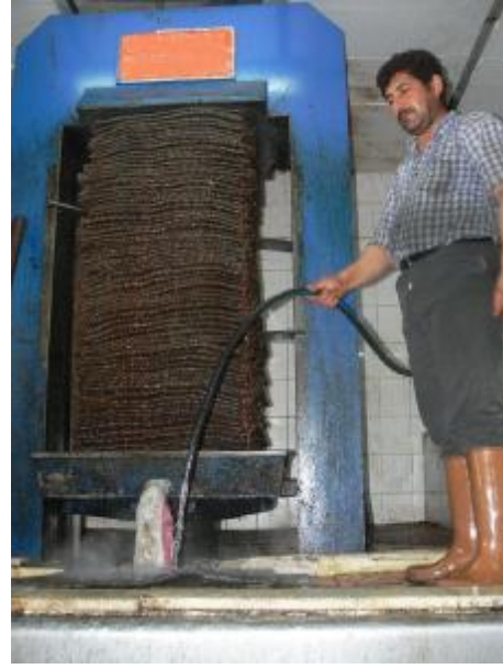
Resim 2.16: Torbalara sıcak su verilmesi
