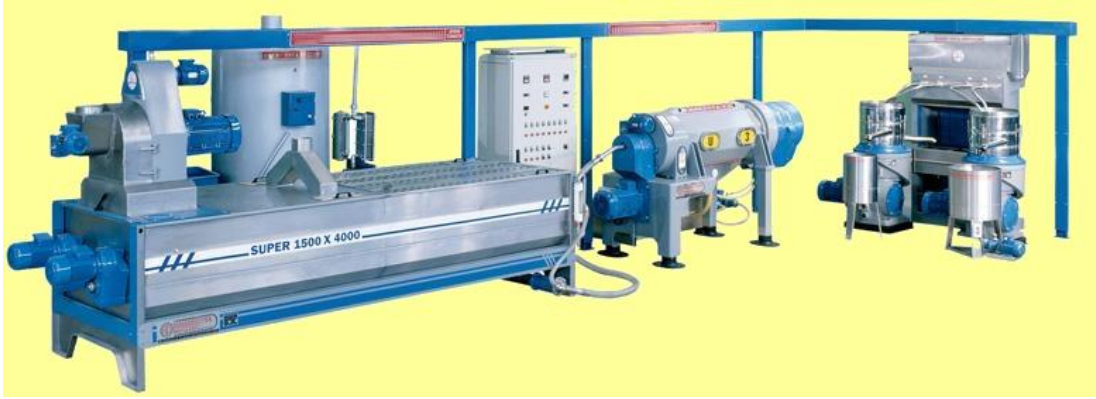
Resim 2.17: Kontinü sistem zeytinyağı üretimi
