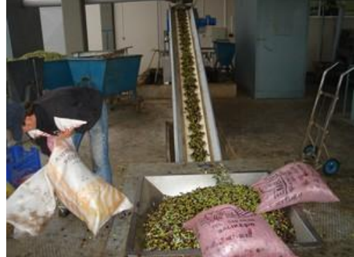
Resim 1.10: Zeytinlerin bunkere boşaltılması
