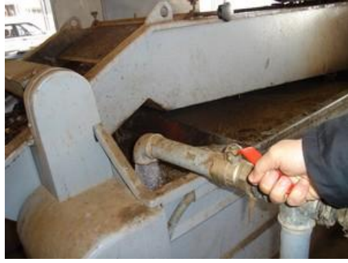
Resim 1.17: Yıkama suyunun değiştirilmesi
