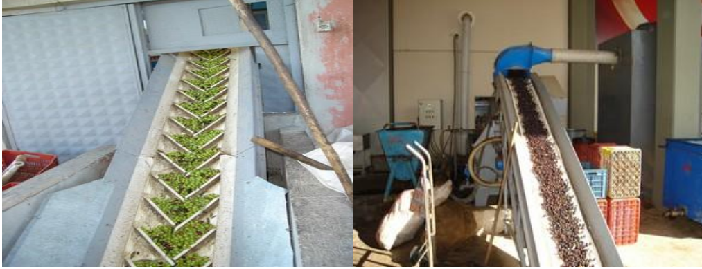
Resim 1.13: Taşıma bantlarında ilerleyen zeytin
