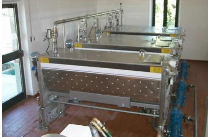
Resim 3.5: Azot beslemeli malaksörler
