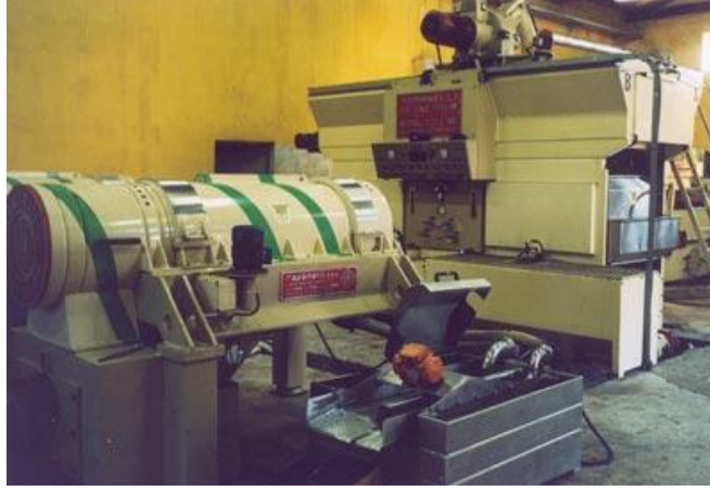
Resim 2.21: Kombine sistem (sinolea+santrifüj) ile zeytinyağı üretimi
