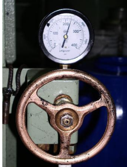
Resim 2.14: Basınç yükseltme vanası
