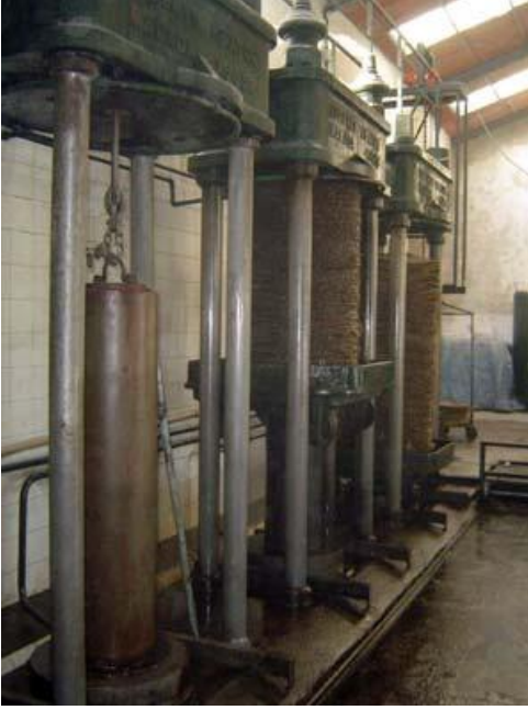
Resim 2.13: Süper preslerde sıkma işlemi
