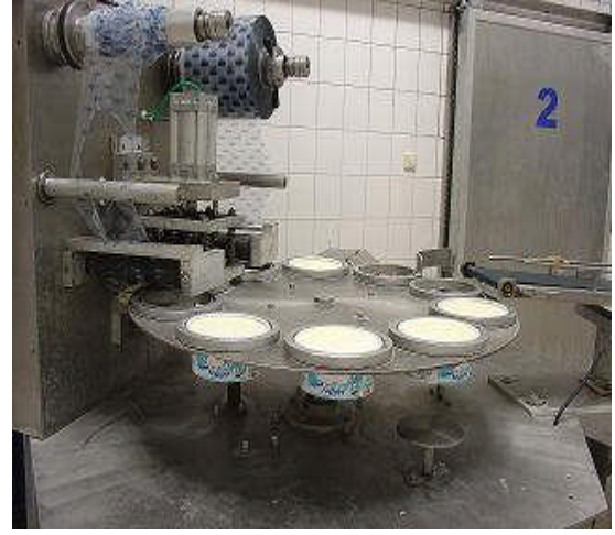
Resim 2.17: Dolumu yapılmış yoğurt ambalajlarının otomatik sistemde kapatılması
