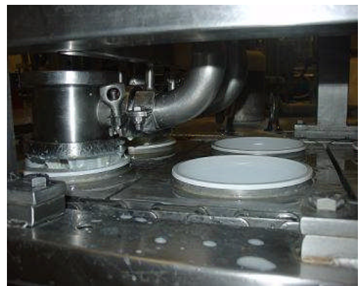
Resim 2.16: Makinelerle hazır yoğurt ambalajlarına dolum
