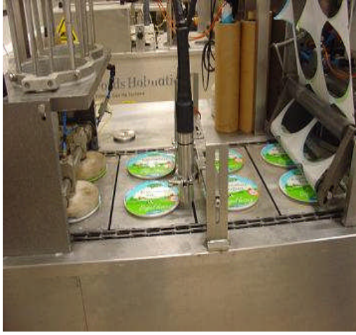
Resim 2.17: Dolumu yapılmış yoğurt ambalajlarının otomatik sistemde kapatılması
