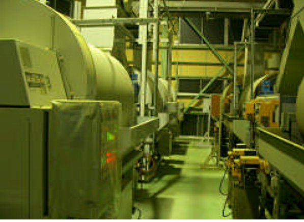
Resim 1.8: Çin usulü kurutma fırını
