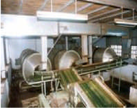
Resim 1.6: Dönel (kuruyemiş) tipli kurutma fırını
