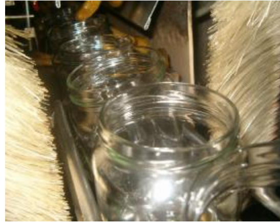
Resim 3.9: Kavanozların dolum ünitesine girmesi
