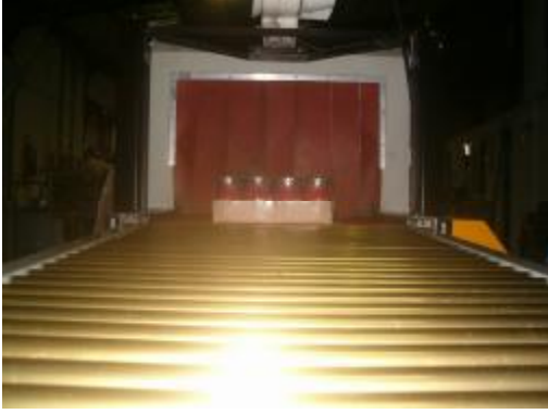
Resim 3.30: Turşuların shrinkleme ünitesinden çıkışı
