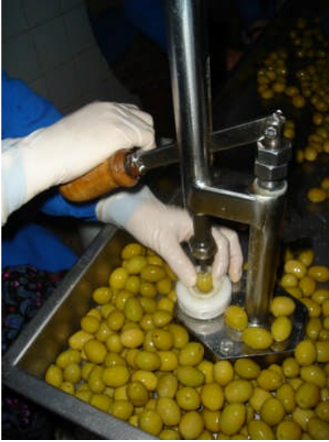
Resim 4.4: Manuel çekirdek çıkarma makinesinin kullanımı
