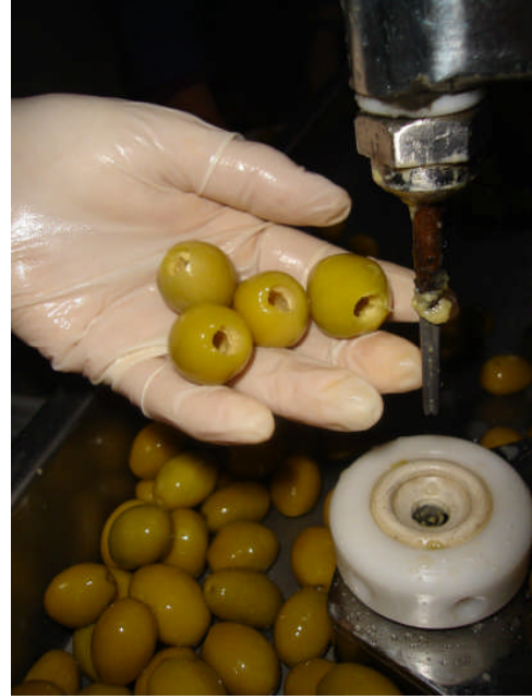
Resim 4.4: Manuel çekirdek çıkarma makinesinin kullanımı
