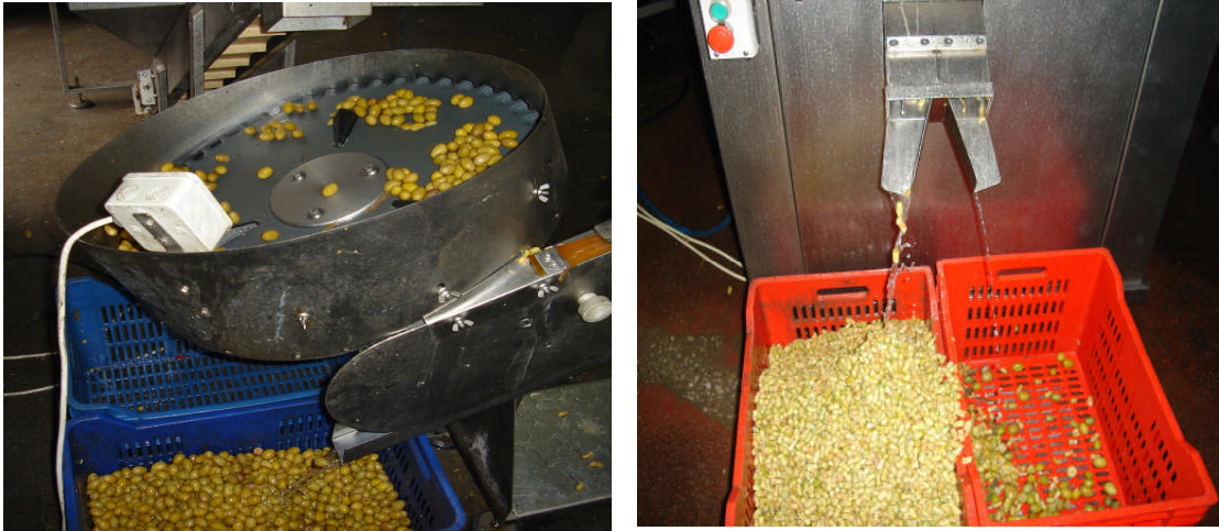
Resim 4.9: Otomatik çekirdek çıkarma makinesinden ürün çıkışı
