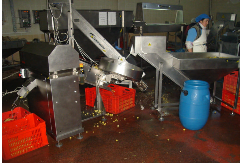
Resim 4.8: İşletmede çalışan otomatik çekirdek çıkarma makinesi resmi
