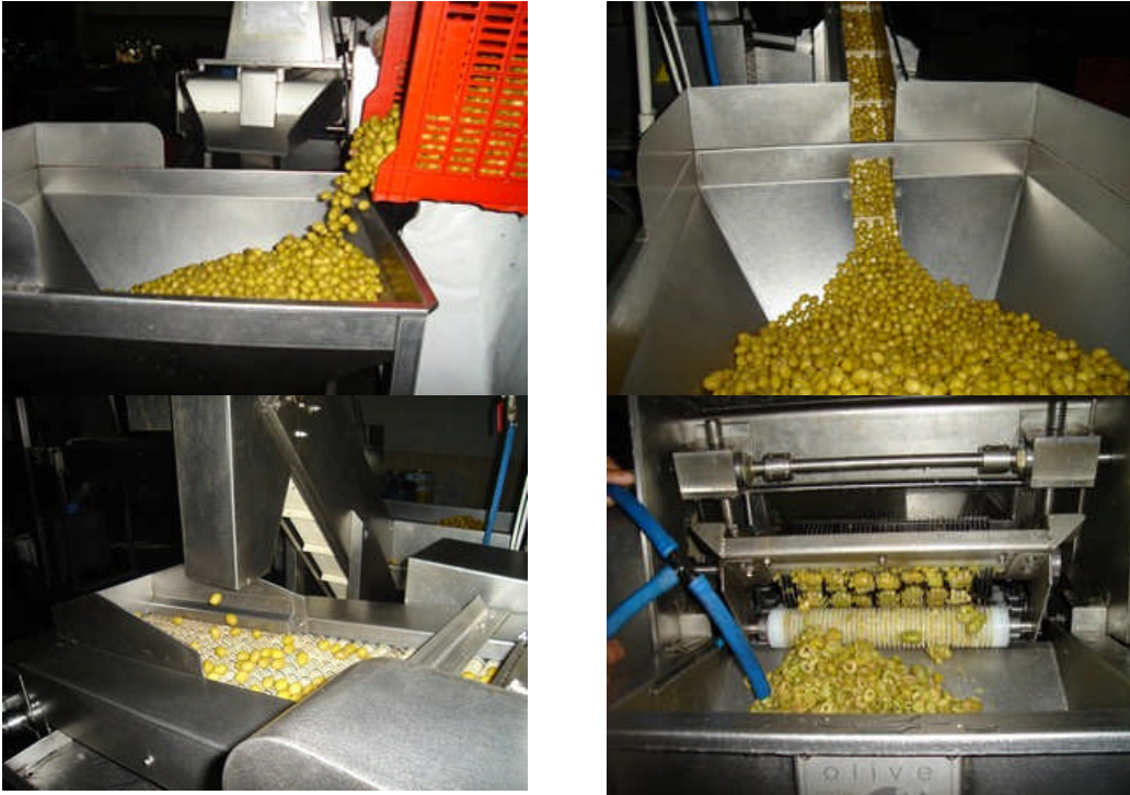
Resim 5.4: Dilimleme makinesinin kullanımı
