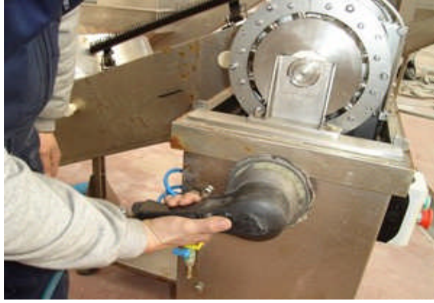
Resim 4.10: Otomatik çekirdek çıkarma makinesinin polisaj makinesi ile temizliği
