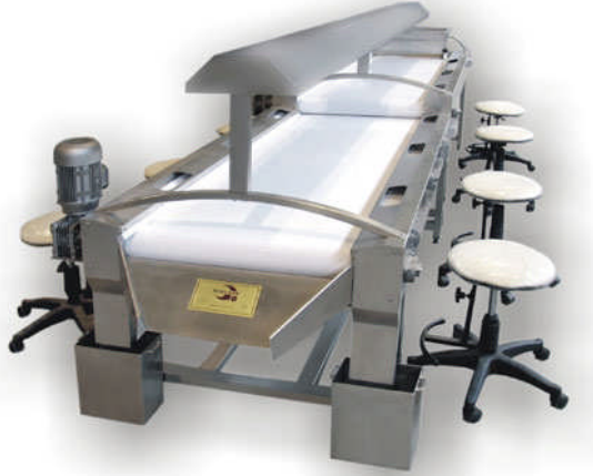
Resim 2.2: Aydınlatmalı ve otuma düzenli ayıklama bandı
