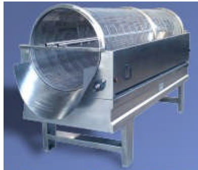
Resim 1.13: Silindir yıkama sistemi
