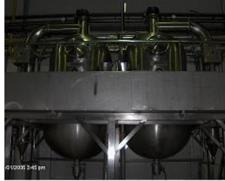
Resim 2.2: Vakumlu reçel pişirme kazanları
