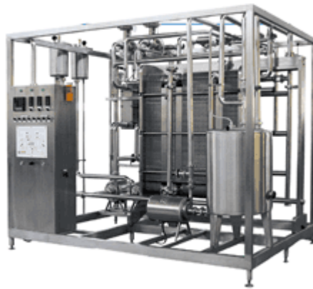
Resim 1.2: Plakalı ısı değıştirme ünitesinin genel görünümü
