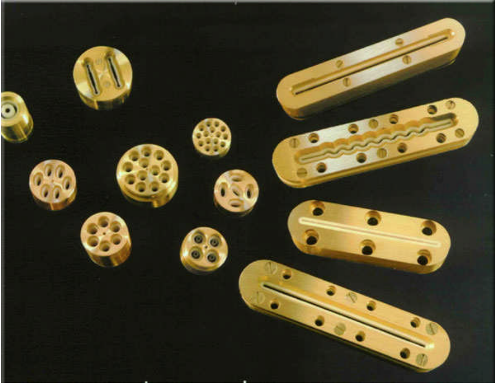
Resim 2. 4: Uzun makarna kartuş/insert örnekleri
