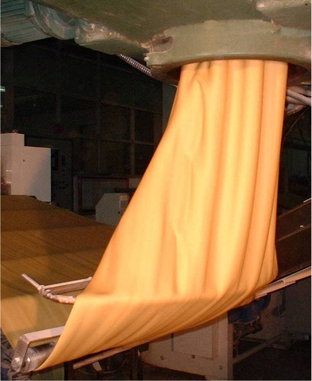
Resim 1.47: Stampa/levha kesme makarnalarda hamurun açılması
