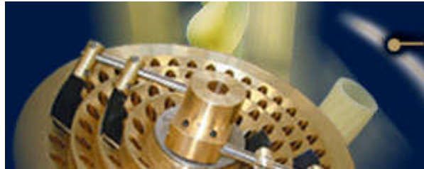
Resim 2.19: Kalıp altında çoklu bıçak
