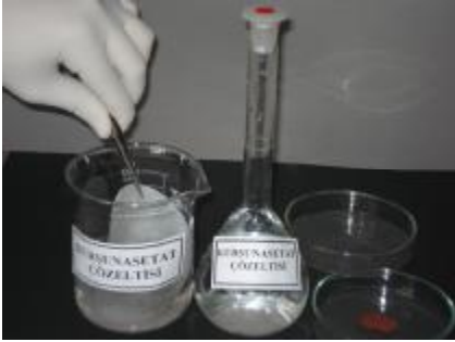
Resim 2.4: Süzgeç kâğıdını kurşunasetat çözeltisine batırma
