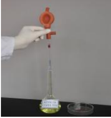
Resim 1.3: Numuneye Nessler çözeltisi ilave etme
