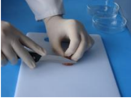
Resim 1.2: Numuneden bıçakla kesit alma
