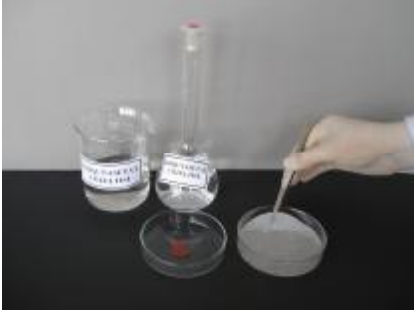
Resim 2.5: Süzgeç kâğıdını petri kutusu kapağına yerleştirme.
