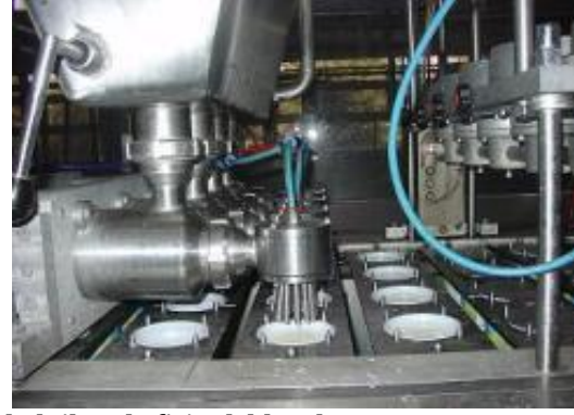
Resim 3.3: Makinelerle plastik ambalajlara kefirin doldurulması
