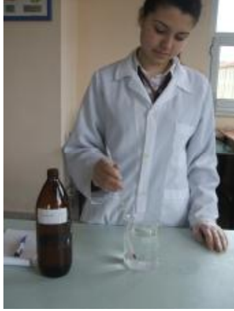
Resim 1.4:Termometreyi kaba daldırma
