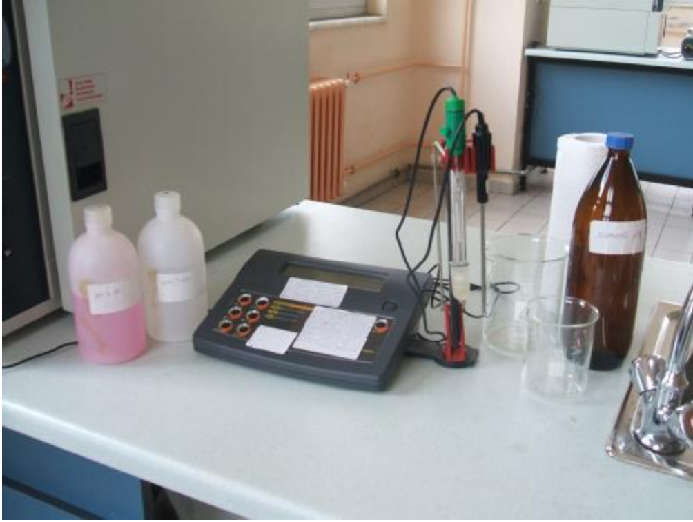
Resim 2.1:pHmetre ve tampon çözeltiler
