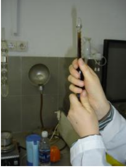
Resim 1.9:Bütrometrenin tıpasını gevşetme
