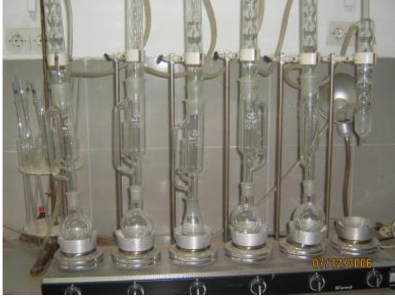
Resim 2.1:Sokselet ekstraksiyon cihazı
