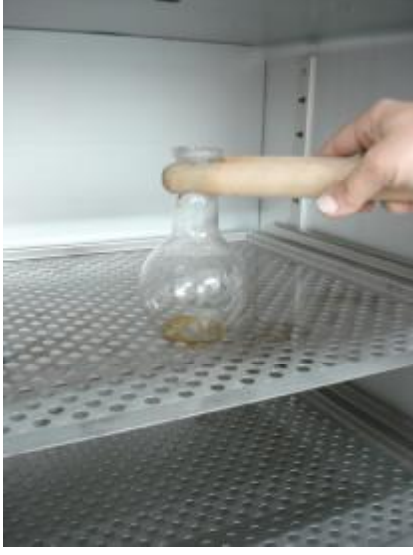
Resim 2.13: Petrol eterinin fazlalığını etüvde uçurma
