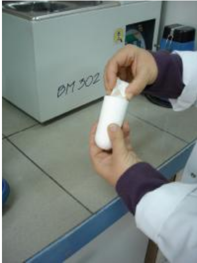
Resim 2.5: Süzgeç kağıdıyla kartuşa yerleştirme
