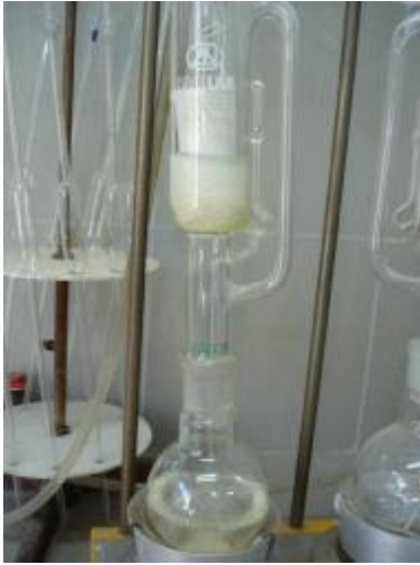
Resim 2.10: Ekstraksiyon işlemi yapma
