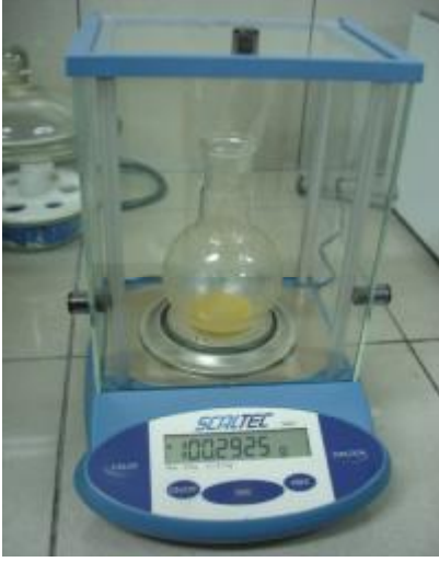
Resim 2.15:Cam balonu tartma
