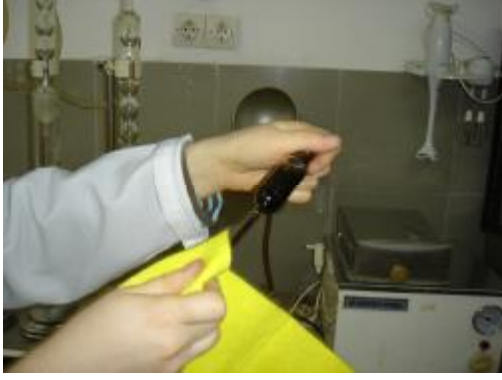
Resim 1.6: Bütrometreyi alt üst etme
