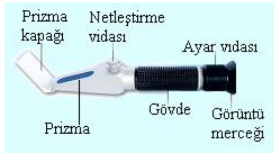
Resim 2.5: Refraktometre ve kısımları
