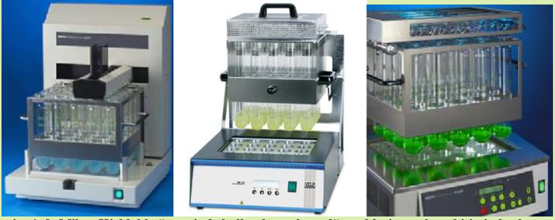
Resim 1. 9: Mikro Kjeldahl yönteminde kullanılan yakma düzenekleri ve yakma bitiminde oluşan renkler.
