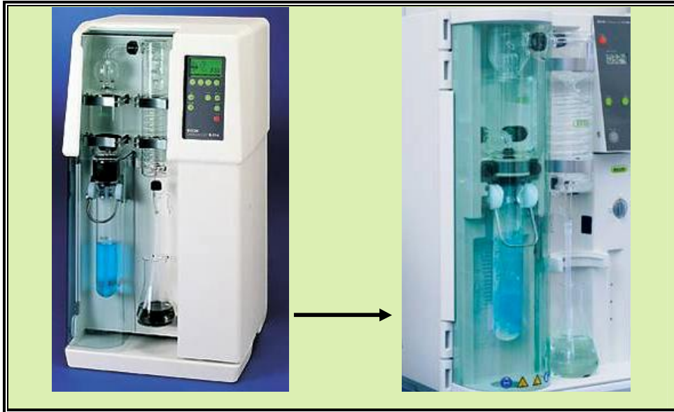
Resim 2. 3: Mikro Kjeldahl yönteminde kullanılan damıtma düzenekleri ve damıtma bitiminde oluşan renkler.
