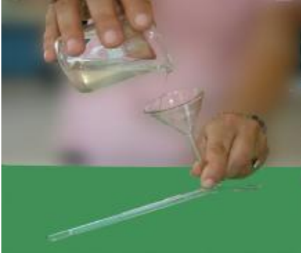
Resim 1.12 . Hidrometri büretine sabun çözeltisi doldurma
