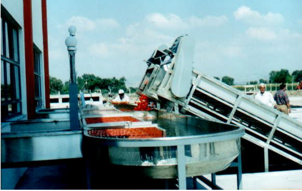
Resim 2.1: Salça üretim fabrikalarında ön yıkama ünitesi
