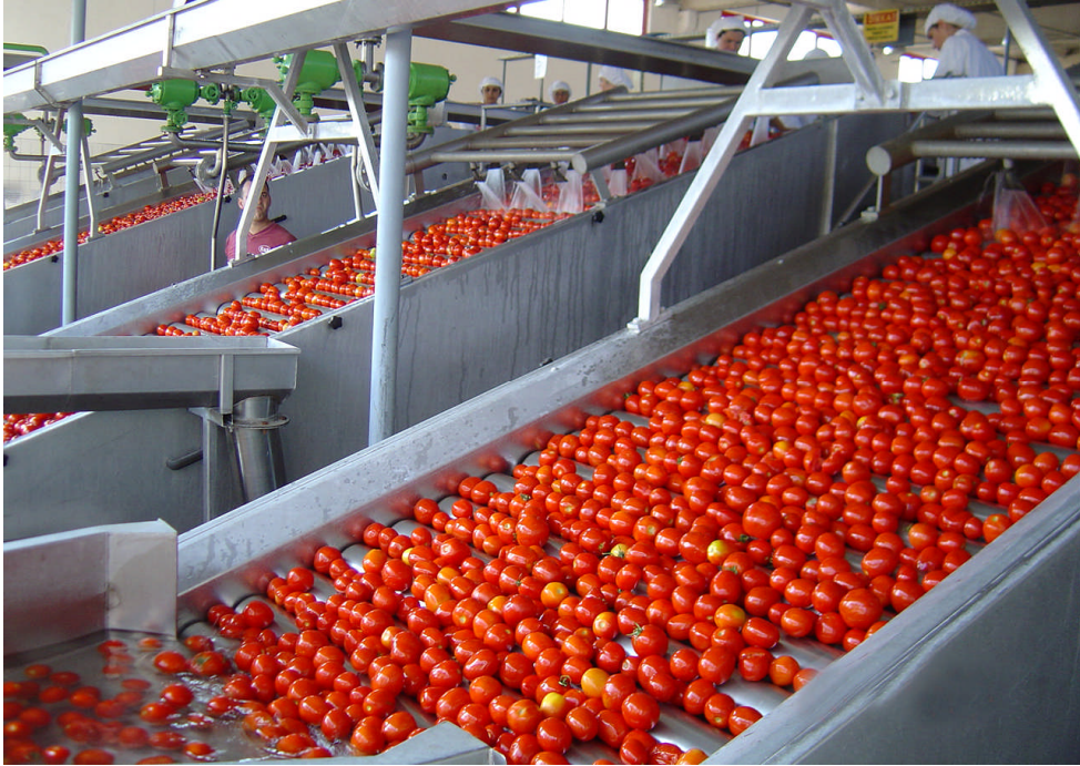
Resim 2.2: Salça üretim fabrikalarında ayıklama ve yıkama üniteleri
