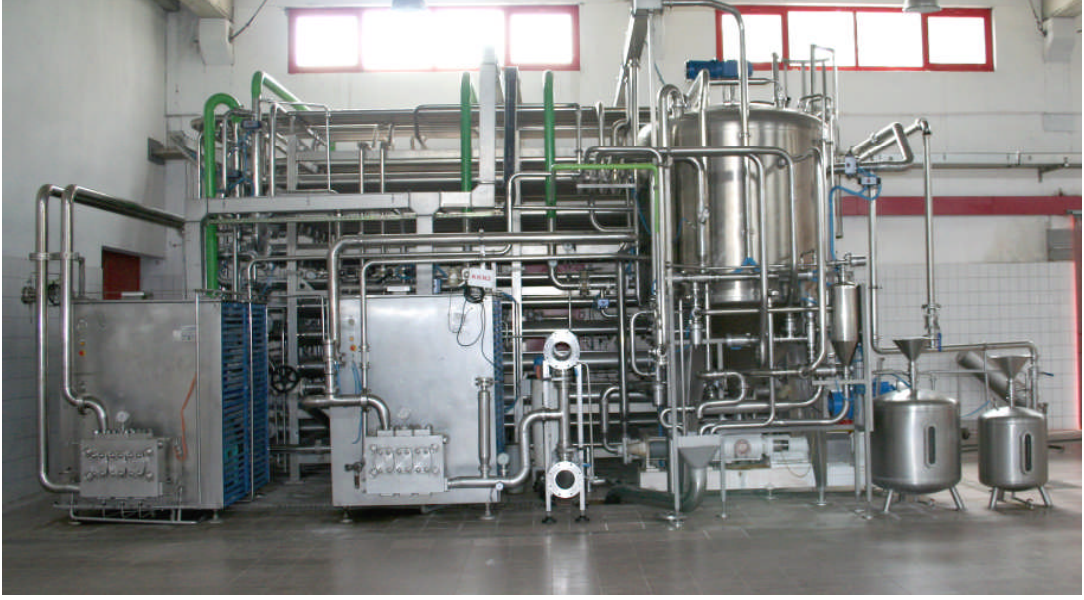
Resim 4.2: Salça fabrikalarında kullanılan sterilizasyon ünitesi
