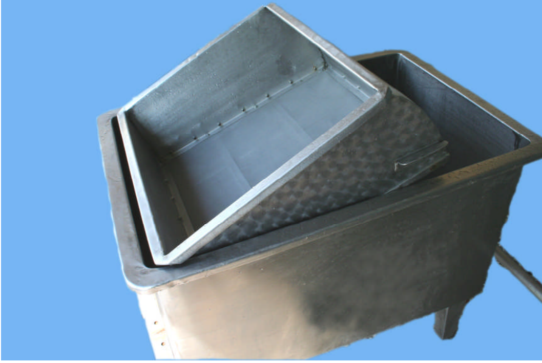
Resim 2.3: Süt işletmesinde ön filtre ekipmanı
