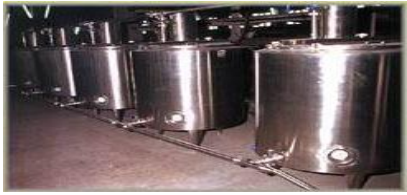
Resim 2.4: CIP sistemine tasarlanmış tanklar
