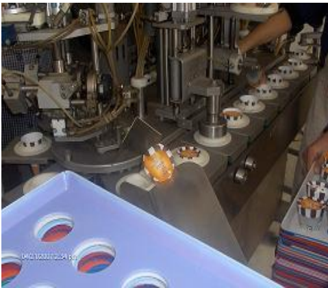
Resim 2.9 -2.10: Kornet ambalajlanması ve özel plastik kasalara yerleştirilmesi
