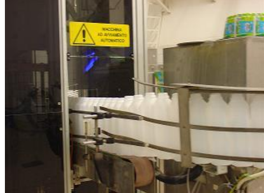
Resim 3.8: Şekillendirilen plastik ambalajın etiketleme makinesine gönderilmesi
