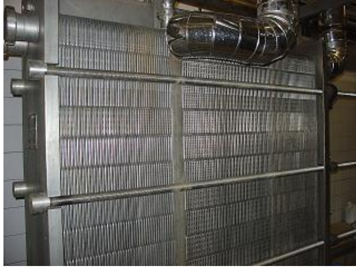
Resim 3.1: Salamura suyunun pastörize edildiđi, titanyumdan yapılmış plakalı ısı değıştirici
