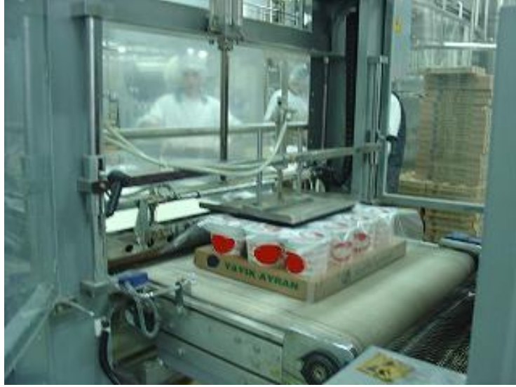
Resim 3.21: Otomatik olarak şrinkleme (karton viyol) -Aşama 1
