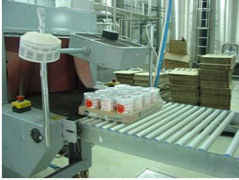
Resim 3.23: Otomatik olarak şrinkleme (karton viyol)-Aşama 3
