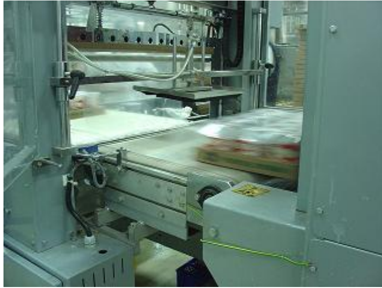
Resim 3.22: Otomatik olarak şrinkleme (karton viyol) -Aşama 2
