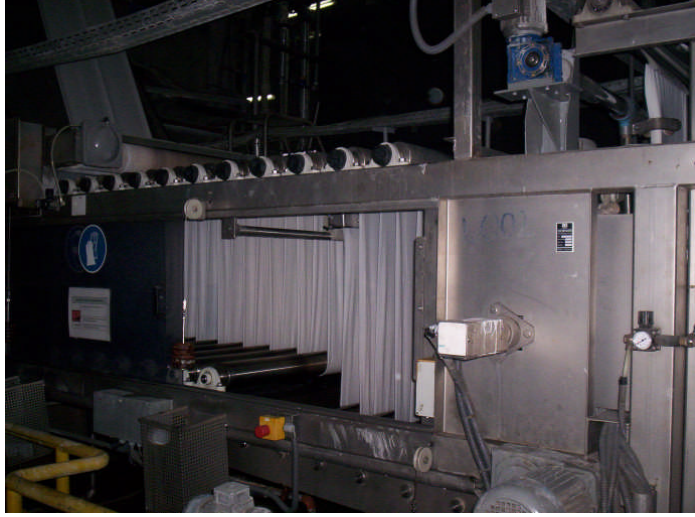
Resim 1. 9: Açık en kumaş yıkama makinesi
