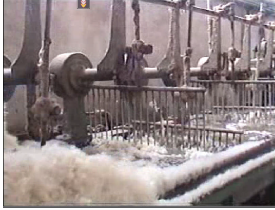
Resim 1. 2: Yapak yıkama makinesi teknesi
