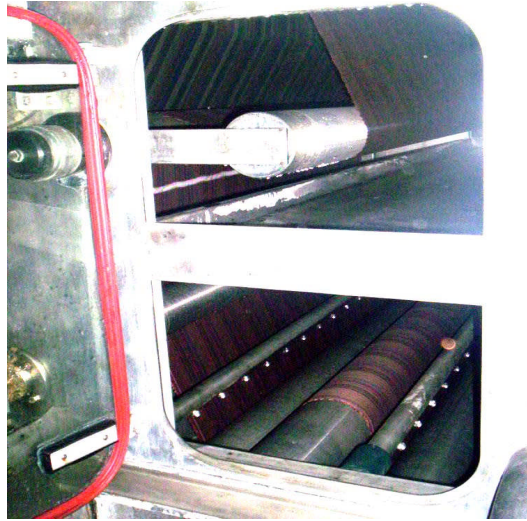
Resim 1. 6: Yıkama makinesinden kumaş geçişi
