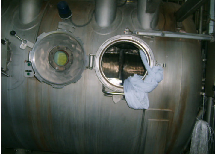
Resim 2.1 :Optik beyazlatma işleminin yapıldığı jet boyama makinesi
