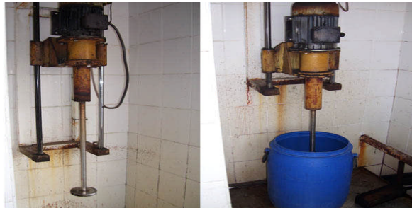
Resim 2.7: Boya mutfağında boyarmaddenin mikser ile hazırlanması
