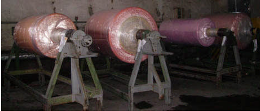
Resim 2.4: Pad-batch yönteminde flotte emdirilmiş kumaşın doklar hâlinde bekletilmesi
