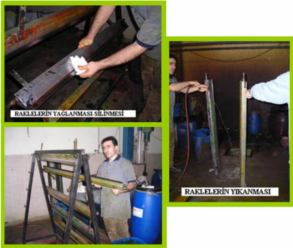
Resim 3.2 :Raklelerin bakımı ve temizliđi
