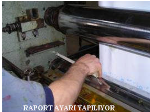
Resim1.4: Rulo baskı silindir ayarları
