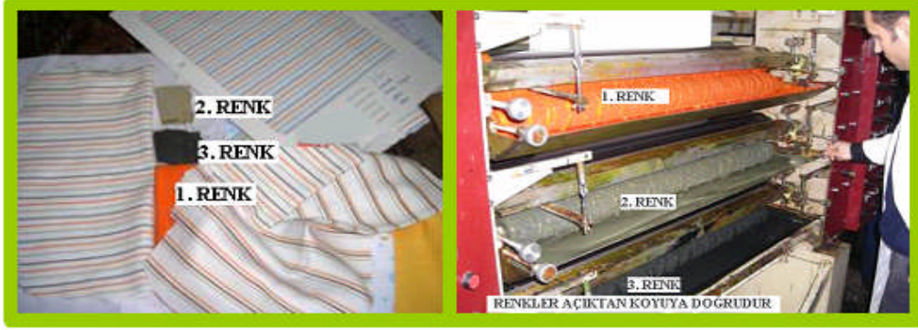
Resim 1.5 : Rulo baskı silindiri makineye yerleştirme sırası
