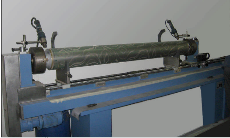
Resim 3.4: Üflelemeli ısıtma sistemli şablon kafası takma makinesi
