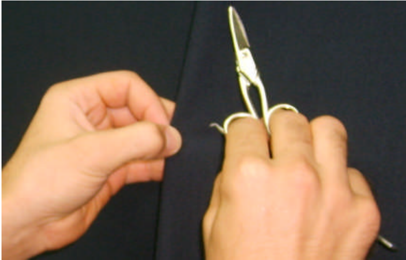
Resim 1.4: Cımbız ve el makası ile hataların giderilmesi
