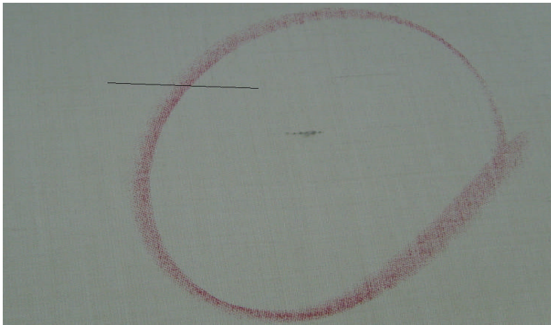
Resim 1.2: Ham kontrol esnasında hataların işaretlenmesi
